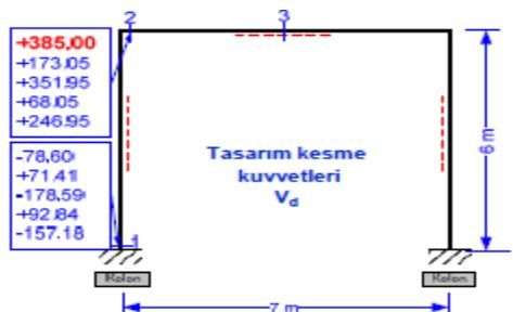
Kesme kuvvetinin işaretini betonarme hesabın sonucunu değiştirmez. Mutlak değerce en büyük kesme kuvveti betonarme hesaba esas alınır.
