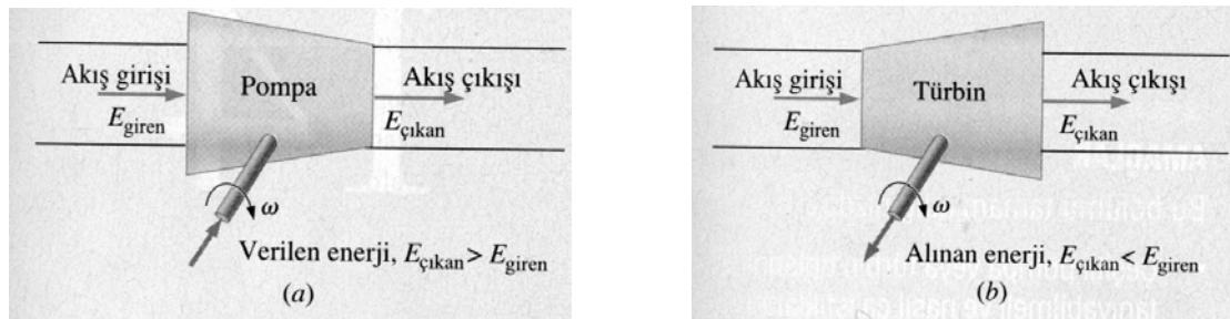
**Şekil 1.1. Pompa (a) ve türbinin (b) çalışma prensibi.**
